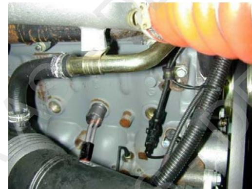
N Før montering kobles minuskabelen av batteriet. Demontér starteren. Demonter frostlokket og monter varmeren. Monter tilbake starteren og batteriets minuskabel. Fyll på godkjent kjølevæske, og luft systemet ifølge bilprodusentens spesifikasjoner. Kontroller for lekkasjer.
