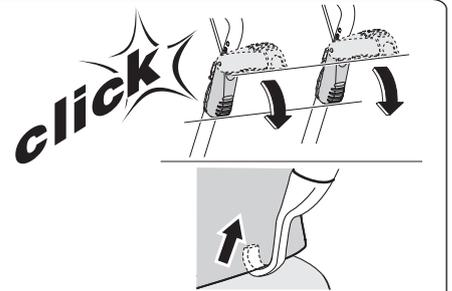
\* **S** Kontrollera att krokarna går fritt vid stängning. Om de undre krokarna tar emot stötfångaren kan gummiskyddet delas och monteras på sidorna av de undre krokarna.
