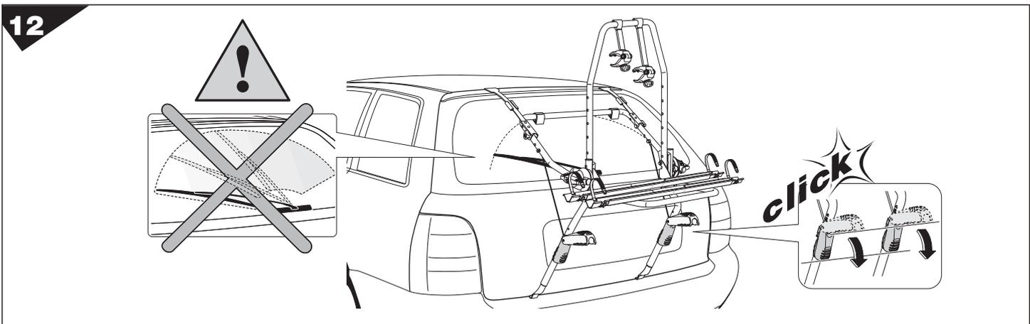
**S** Max tillåten last 2 x 15 kg • **GB** Max. permitted load 2 x 15 kg • **D** Max. Zuladung 2 x 15 kg • **F** Pression maxi autorisée 2 x 15 kg
