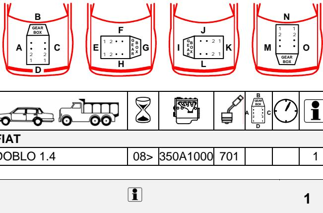
**N** Demonter platen under motoren.
