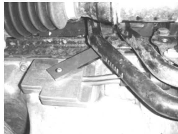
OBS ! Bilar med Webasto: Placera spännjärnet under hållaren till rören. Bocka elementröret så de går fritt från tråget.
